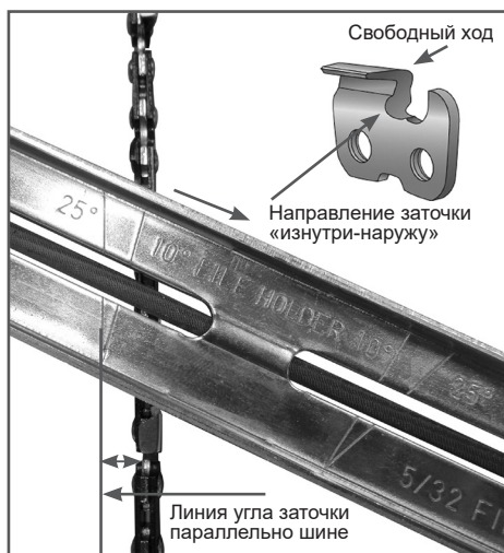
Рис. 16 Определение угла заточки
