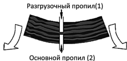
Рис. 11 Распиливание дерева, когда его нижняя часть находится под напряжением
